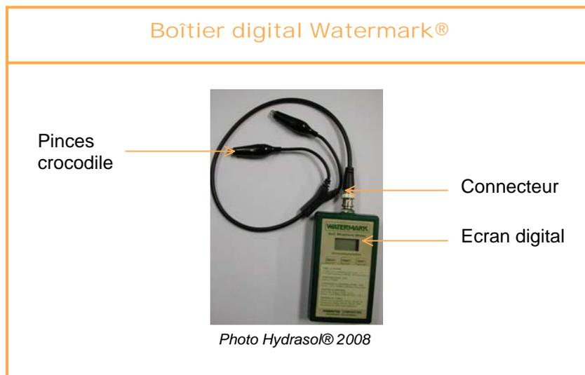
Le boîtier digital Watermark® permet la lecture manuelle des sondes tensiométriques Watermark®. Le boîtier convertit la valeur électrique de la résistance de la sonde en une valeur de tension calibrée en fonction de la température et exprimée dans une plage de 0 à 200 centibars. Le boîtier digital Watermark® est un produit d'Irrometer Compagny Inc.
